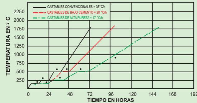
"Retener la temperatura 1 hora por cada pulgada de espesor del CASTABLE (en la figura espesor = 5")
